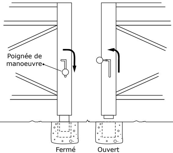
Modèle double, en vis à vis, avec pied embarqué
